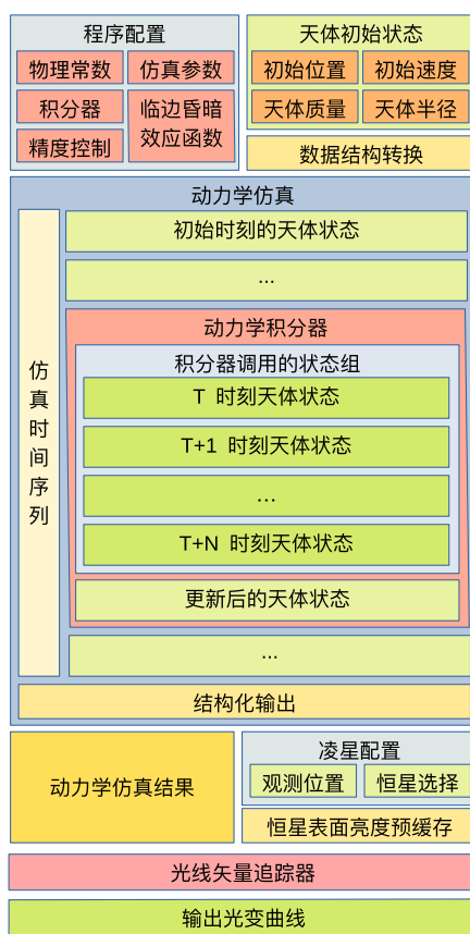
图 1 本方法的程序结构示意图。其中，程序配置、凌星配置和动力学积分器等三个部分可以由用户配置和指定。
