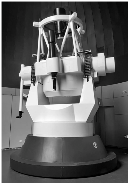
图 1 上海天文馆双焦点可切换一米望远镜
