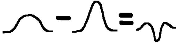
图 6 同一个恒星由于视宁度不同而产生不同的 PSF, 以及相减后的图像示意图
